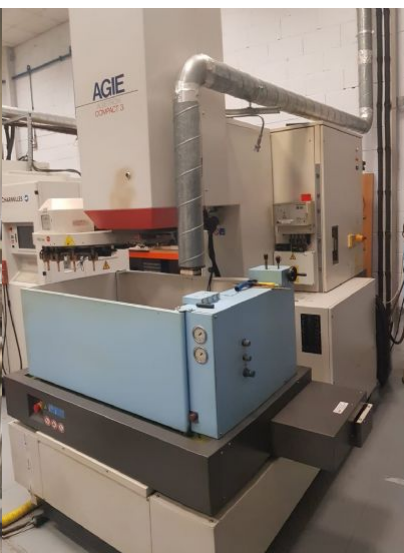
Electroerosión por penetración CHARMILLES COMPACT 3
