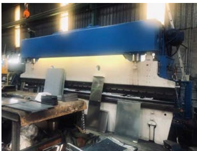
Plegadora hidráulica 6000 mm x240 ton AJIAL 6x240 Ref: LLM-001
